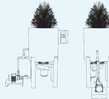
Su funcionamiento es práctico, ya que sólo se necesita colocar el garrafón invertido en el cepillo y accionar el botón de encendido, en este momento el cepillo girará a altas revoluciones e inyectará detergente al interior del garrafón.
