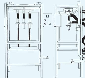
Cabezal neumático de llenado con válvulas especiales tipo retorno.
