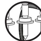
3 Válvulas de llenado tipo retorno, diseño exclusivo Puritronic, se llenan los envases uniformemente sin derrame de líquido
