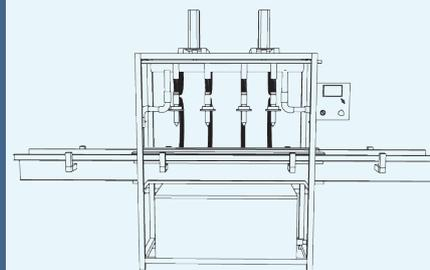
Cabezal neumático de llenado con válvulas especiales tipo retorno.
