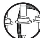
4 Válvulas de llenado tipo retorno, diseño exclusivo Puritronic, se llenan los envases uniformemente sin derrame de líquido
